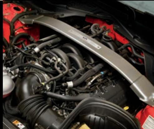
El Sistema de Amortiguación MagneRide™ hace pasar una corriente eléctrica a través del fluido hidráulico con infusión de hierro, a fin de ajustar sus amortiguadores controlados continuamente de manera independiente en cada esquina – 1,000 veces por segundo. MagneRide, un soporte de torre de puntal de aluminio y enfriadores para el aceite del motor, de la transmisión y del diferencial son, todos, estándar en cada GT350 para 2017.
